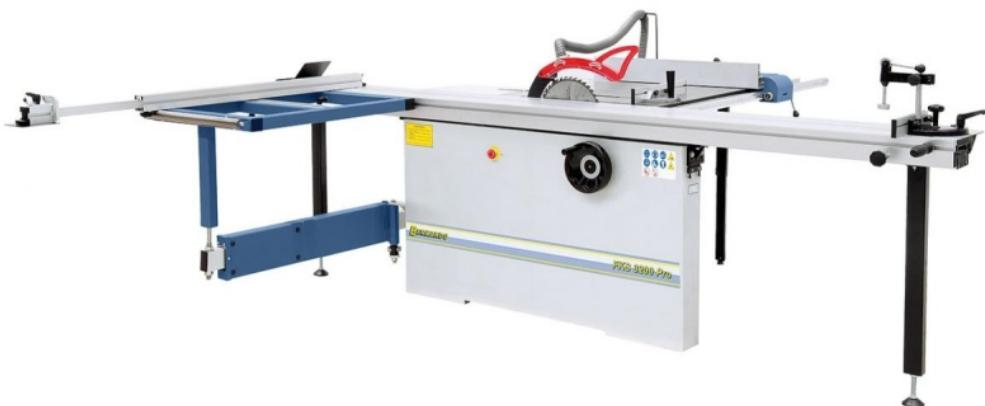
Die Formatkreissägen der FKS-Serie sind je nach Anwendung wahlweise mit drei verschiedenen Tischlängen lieferbar (2600 / 2800 / 3200 mm). Serienmäßig ausgestattet mit einem 3,8 kW Motor und einem Sägeblatt mit 315 mm Durchmesser für Schnitthöhen bis 100 mm, sowie einem Vorritzagggregat für ein ausreißfreies Bearbeiten beschichteter Plattenwerkstoffe.
