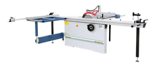
Die Formatkreissägen der FKS-Serie sind je nach Anwendung wahlweise mit drei verschiedenen Tischlängen lieferbar (2600 / 2800 / 3200 mm). Serienmäßig ausgestattet mit einem 3,8 kW Motor und einem Sägeblatt mit 315 mm Durchmesser für Schnitthöhen bis 100 mm, sowie einem Vorritzaggregat für ein ausreißfreies Bearbeiten beschichteter Plattenwerkstoffe.
