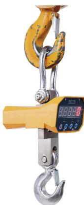
Der Bernardo CW 3000 Kranwaagen ist ein hochpräzises Messgerät für die Gewichtsmessung von Lasten. Die maximale Traglast beträgt 3000 kg, die Messgenauigkeit liegt bei 1 kg. Die Abmessungen betragen A: 315 mm, B: 430 mm und C: 540 mm. Das Gewicht des Geräts beträgt etwa 15 kg.
