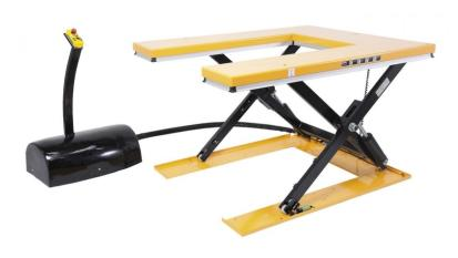
Der Bernardo FSHT 1000 U Scherenhubtische mit U-Plattform ist ein vielseitiges Arbeitsgerät. Die Plattform ist 1450 x 1140 mm groß und bietet eine lichte Weite von  $580 \times 1080$  mm. Das Bedienpult misst  $670 \times 420 \times 920$  mm. Die Höhenverstellung reicht von 85 bis 875 mm. Die Tragkraft beträgt maximal 1000 kg.
