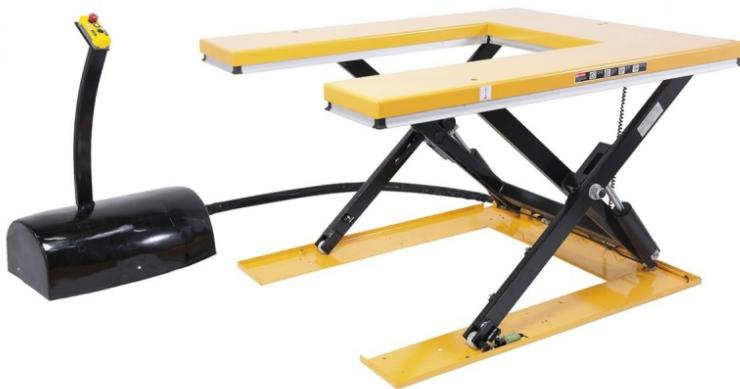
Der Bernardo FSHT 1000 U Scherenhubtische mit U-Plattform ist ein vielseitiges Arbeitsgerät. Die Plattform ist 1450 x 1140 mm groß und bietet eine lichte Weite von 580 x 1080 mm. Das Bedienpult misst 670 x 420 x 920 mm. Die Höhenverstellung reicht von 85 bis 875 mm. Die Tragkraft beträgt maximal 1000 kg.
