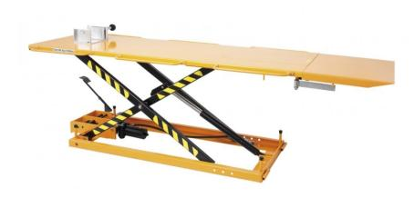
Die Bernardo MHB 500 Motoradhebebühne ist eine professionelle Lösung für die Hebebühnen-Industrie. Die Plattform bietet eine Tragkraft von maximal 500 kg und eine Plattformgröße von 2200 x 700 mm. Die Auffahrrampe misst 550 x 700 mm und die Höhenverstellung beträgt 170 - 820 mm. Die Rad-Spannvorrichtung kann von 0 - 160 mm eingestellt werden.
