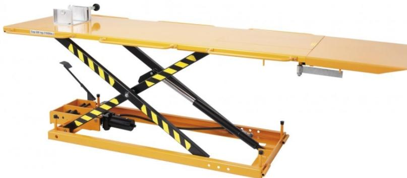
Die Bernardo MHB 500 Motoradhebebühne ist eine professionelle Lösung für die Hebebühnen-Industrie. Die Plattform bietet eine Tragkraft von maximal 500 kg und eine Plattformgröße von 2200 x 700 mm. Die Auffahrrampe misst 550 x 700 mm und die Höhenverstellung beträgt 170 - 820 mm. Die Rad-Spannvorrichtung kann von 0 - 160 mm eingestellt werden.
