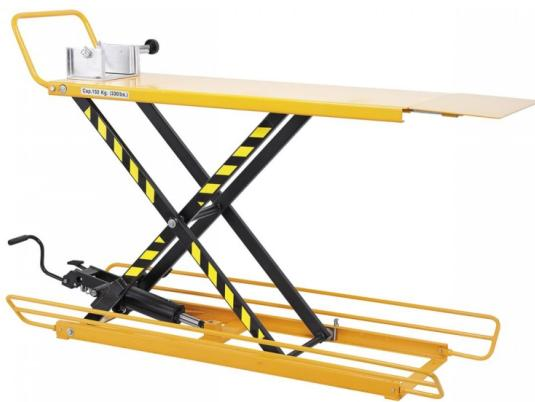
Die Bernardo MHB 150 Motoradhebebühnen ist eine professionelle Lösung für die Hebebühnenbedürfnisse. Die Plattform bietet eine Tragkraft von maximal 150 kg und misst 1400 x 470 mm. Die Auffahrrampe misst 300 x 460 mm und die Höhenverstellung reicht von 145 bis 1100 mm. Die Rad-Spannvorrichtung kann von 0 bis 160 mm justiert werden. Die Maschinenabmessungen betragen 2000 x 720 x 360 (1330) mm und das Gewicht beträgt etwa 110 kg.
