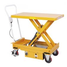
Der Bernardo ES 500 Semielektrische Scherenhubtisch ist ein vielseitiges Werkzeug für verschiedene Anwendungen. Die Tischgröße beträgt 1010 x 520 mm und die Tischhubhöhe kann zwischen 445 - 970 mm eingestellt werden. Der Tisch ist mit Lenkrollen Ø 150 x 40 mm ausgestattet und hat eine Tragkraft von maximal 500 kg. Die Abmessungen des Geräts betragen 1220 x 520 x 1150 mm und es wiegt etwa 145 kg.
