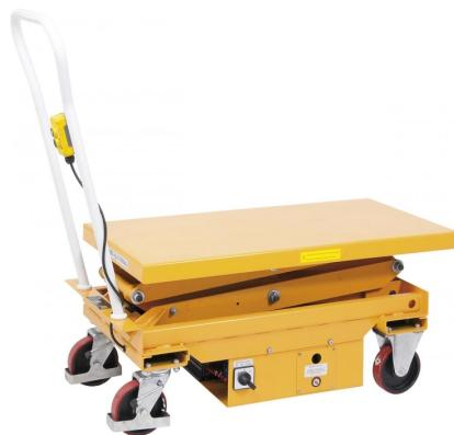
Der Bernardo ES 300 D Semielektrische Doppelscherenhubtisch ist ein vielseitiges Werkzeug für verschiedene Anwendungen. Die Tischgröße beträgt 1010 x 520 mm und die Tischhubhöhe kann zwischen 500 und 1618 mm eingestellt werden. Der Tisch ist mit Lenkrollen mit einem Durchmesser von 150 mm und einer Breite von 40 mm ausgestattet. Die maximale Tragkraft des Tisches beträgt 300 kg.
