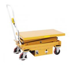
Der Bernardo ES 300 D Semielektrische Doppelscherenhubtisch ist ein vielseitiges Werkzeug für verschiedene Anwendungen. Die Tischgröße beträgt 1010 x 520 mm und die Tischhubhöhe kann zwischen 500 und 1618 mm eingestellt werden. Der Tisch ist mit Lenkrollen mit einem Durchmesser von 150 mm und einer Breite von 40 mm ausgestattet. Die maximale Tragkraft des Tisches beträgt 300 kg.
