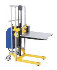
Der Bernardo GH 1200 E ist ein ergonomischer Hebelift, der für den sicheren und effizienten Transport von Lasten konzipiert ist. Mit einer Tragkraft von 400 kg und einer Hubhöhe von bis zu 1480 mm ist er ideal für den Einsatz in verschiedenen Branchen. Die Maschine verfügt über eine manuelle Feststellbremse und eine Lenkrollenabmessung von 125 x 35 mm.
