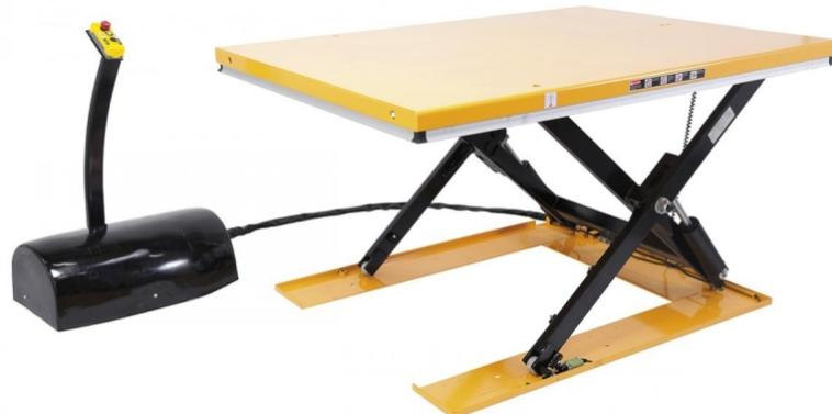
Der Bernardo FSHT 1502 G Scherenhubtische mit geschlossener Plattform ist ein vielseitiges Arbeitsgerät. Die Plattform misst 1600 x 1000 mm und das Bedienpult 670 x 420 x 920 mm. Der Scherenhubtisch bietet eine Höhenverstellung von 105 - 870 mm und eine Tragkraft von max. 1500 kg.
