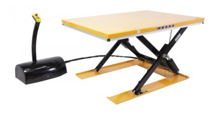
Der Bernardo FSHT 1502 G Scherenhubtische mit geschlossener Plattform ist ein vielseitiges Arbeitsgerät. Die Plattform misst 1600 x 1000 mm und das Bedienpult 670 x 420 x 920 mm. Der Scherenhubtisch bietet eine Höhenverstellung von 105 - 870 mm und eine Tragkraft von max. 1500 kg.
