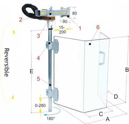
Die Bernardo PST 01/260 Schutzeinrichtungen für Stoßmaschinen bietet einen umfassenden Schutz für den Bediener. Diese Schutzeinrichtung ist in zwei Abmessungen erhältlich und schützt den Bediener vor direktem Kontakt mit bewegten Teilen des vertikalen Schlittens und vor wegfiegenden Spänen.
