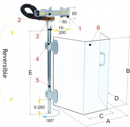
Die Bernardo PST 01/240 Schutzeinrichtungen für Stoßmaschinen sind in zwei Abmessungen erhältlich und schützen den Bediener vor direktem Kontakt mit bewegten Teilen des vertikalen Schlittens und vor wegflogenden Spänen. Dieses Modell ist wahlweise für die Montage links oder rechts am Maschinenkörper erhältlich. Der Schutzschirm besteht aus einem schlagfesten und ölbeständigen Kunststoffmaterial. Komplett mit Sicherheits-Mikroschalter.
