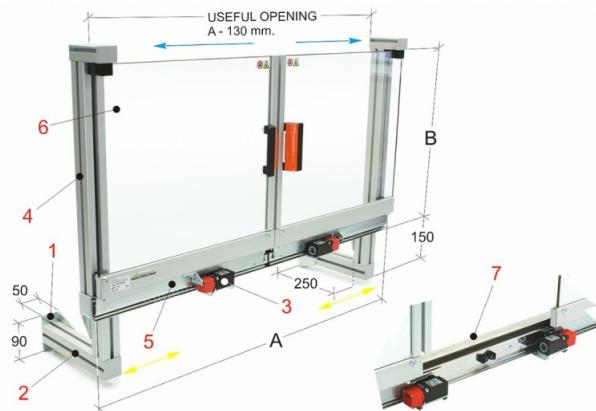
Der Bernardo PRE 10/655 Schutzeinrichtungen für die Installation auf dem Maschinentisch ist eine wichtige Sicherheitsvorkehrung für den Bediener. Er schützt vor direktem Kontakt mit rotierenden Teilen der Spindel und vor wegfliegenden Spänen und Kühlmittelspritzern.
