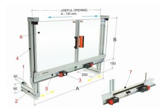
Der Bernardo PRE 10/655 ist eine Schutzeinrichtung für die Installation auf dem Maschinentisch. Die Konstruktion ist vielfach einstellbar und verfügt über zwei unterschiedliche Befestigungssysteme. Der Rahmen besteht aus Aluminiumprofil und die Kugelführungen haben eine Weglänge, die der Baulänge entspricht.
