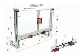
Der Bernardo PRE 10/550 ist eine Schutzeinrichtung für die Installation auf dem Maschinentisch. Die Konstruktion ist vielfach einstellbar und verfügt über zwei unterschiedliche Befestigungssysteme. Ein Sicherheits-Mikroschalter mit eigenem Auslöser und 2 Öffnungskontakten sorgt für zusätzliche Sicherheit.
