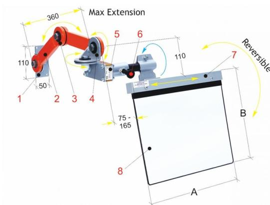
Die Bernardo PBF 10/435 Schutzeinrichtungen für diverse Maschinen sind universelle Schutzeinrichtungen mit feststellbaren Gelenk-armen und umkehrbarer Öffnungsrichtung. Sie sind praktisch und sofort einstellbar, für häufigen Arbeitswechsel konstruiert. Die Schutzeinrichtungen schützen den Bediener vor direktem Kontakt mit wegfliegenden Metallspänen, welche an der Vorderseite durch den Schutzschirm abgewehrt werden.
