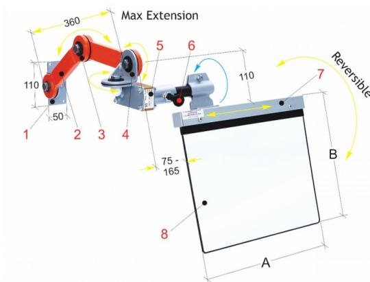
Die Bernardo PBF 10/350 Schutzeinrichtungen für diverse Maschinen sind universelle Schutzeinrichtungen mit feststellbaren Gelenk-armen und umkehrbarer Öffnungsrichtung. Sie sind praktisch und sofort einstellbar, für häufigen Arbeitswechsel konstruiert. Die Schutzeinrichtungen schützen den Bediener vor direktem Kontakt mit wegfliegenden Metallspänen, welche an der Vorderseite durch den Schutzschirm abgewehrt werden.
