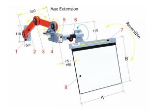
Der Bernardo PBF 10/350 ist eine Schutzeinrichtung für diverse Maschinen. Die Schutzeinrichtung besteht aus einem Winkelhalter aus Stahlblech, einem Gelenkarm aus Stahlrohr, einem einstellbaren Gelenk mit Reibscheibe, einem Träger für die vertikale Kippbewegung des Schutzschirms, einem 180° drehbaren Hauptgehäuse und einem Sicherheits-Mikroschalter mit 2 Öffnungskontakten.
