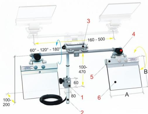
Die Bernardo PMA 11/216 Schutzeinrichtungen für Schleifmaschinen sind universell einstellbar und bieten Schutz vor wegfliegenden Funken und Schleifstaub. Der Aufbau aus Sechskantmaterial ermöglicht eine einfache Anpassung an unterschiedliche Gegebenheiten.
