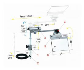
Die Bernardo PMA 10/216 Schutzeinrichtungen für Schleifmaschinen sind universell einstellbar und können auf verschiedenen Schleifmaschinen wie Werkzeugschleifmaschinen und Doppelschleifmaschinen montiert werden. Ein Mikroschalter ist im Tragescharnier integriert, um den Bediener vor wegfliegenden Funken und Schleifstaub zu schützen.
