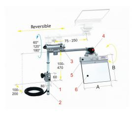
Die Bernardo PMA 10/112 Schutzeinrichtungen für Schleifmaschinen sind universell einstellbar und können auf verschiedenen Schleifmaschinen, wie z.B. Werkzeugschleifmaschinen und Doppelschleifmaschinen, montiert werden. Ein Mikroschalter ist im Tragescharnier integriert, um den Bediener vor wegfliegenden Funken und Schleifstaub zu schützen.
