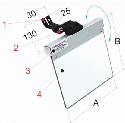
Die Bernardo PMA 2/216 Schutzeinrichtungen für Schleifmaschinen sind speziell zur Montage auf Bandschleifmaschinen, Doppelschleifmaschinen oder ähnlichen Maschinen konzipiert. Diese Schutzeinrichtung schützt den Bediener vor wegfliegenden Funken und Schleifstaub. Sie verfügt über ein feststellbares Drehgelenk für schnelle Einstellung und einem großen Schutzglas aus schlagfestem Kunststoffmaterial.
