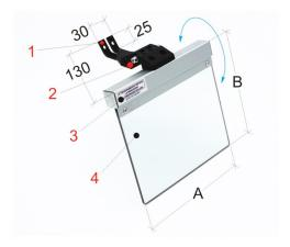
Die Bernardo PMA 2/216 Schutzeinrichtungen für Schleifmaschinen sind speziell zur Montage auf Bandschleifmaschinen, Doppelschleifmaschinen oder ähnlichen Maschinen konzipiert. Diese Schutzeinrichtung schützt den Bediener vor wegfliegenden Funken und Schleifstaub. Sie verfügt über ein feststellbares Drehgelenk für schnelle Einstellung und einem großen Schutzglas aus schlagfestem Kunststoffmaterial.
