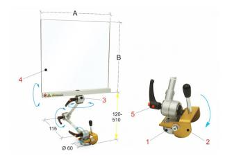
Der Bernardo PBM 30/440 Schutzschild mit Befestigungsmagnet ist eine universelle Schutzeinrichtung, die durch einen kräftigen Neodym-Magneten auch vertikal positioniert werden kann. Die Schutzeinrichtung ist komplett mit Lösehebel und kann auf metallischen Arbeitsflächen und Maschinensockeln befestigt werden. Die vielfältigen Verwendungsmöglichkeiten erlauben eine Verwendung des Schutzschirms in jeder beliebigen vertikalen oder horizontalen Position.
