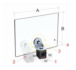
Der Bernardo PBM 20/325 Schutzschild ist eine universelle Schutzeinrichtung mit Magnetfuß, das Schutzglas ist in 2 Positionen einstellbar. Der Schutzschirm schützt den Bediener vor Funken, Stäuben und kleinen Teilen, welche während der Bearbeitung entstehen können. Er ist für die Verwendung auf Maschinenkörpern und ebenen Stahloberflächen geeignet.
