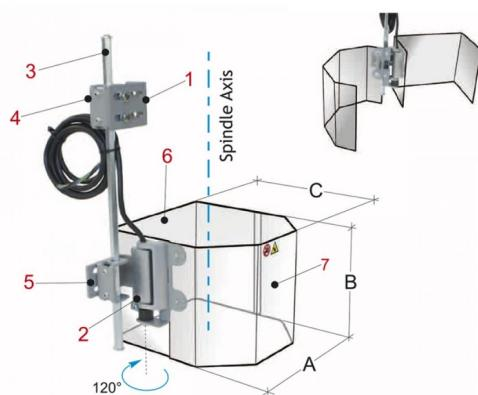
Die Bernardo PTR 30/130 Schutzeinrichtungen für Bohrmaschinen sind universelle und stabile Vorrichtungen mit komplett geschlossenem Schutz und seitlicher Öffnen des Schutzschirms über Scharnier inklusive eingebautem Mikroschalter.
