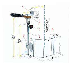
Der Bernardo PTR 20/300 ist eine Schutzeinrichtung für Bohrmaschinen. Diese Schutzeinrichtung schützt den Bediener vor direktem Kontakt mit rotierenden Teilen der Spindel und vor wegfliegenden Spänen sowie Kühlmittelspritzern.
