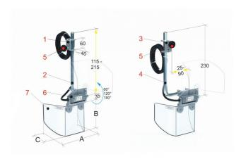
Die Bernardo PTR 11/180 ist eine Schutzeinrichtung für diverse Maschinen. Sie verfügt über ein doppeltes Befestigungssystem, welches durch einstellbare Sechskantarme gehalten wird. Der Sicherheits-Mikroschalter ist im Spezialscharnier integriert, welches den Schutzschirm trägt. Der Schutzschirm schützt den Bediener vor direktem Kontakt mit rotierenden Teilen der Spindel und vor wegfliegenden Spänen sowie Kühlmittelspritzern.
