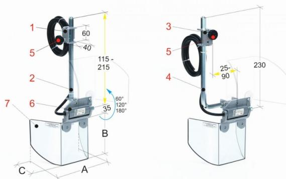
Die Bernardo PTR 11/180 ist eine Schutzeinrichtung für diverse Maschinen. Sie verfügt über ein doppeltes Befestigungssystem, welches durch einstellbare Sechskantarme gehalten wird. Der Sicherheits-Mikroschalter ist im Spezialscharnier integriert, welches den Schutzschirm trägt. Der Schutzschirm schützt den Bediener vor direktem Kontakt mit rotierenden Teilen der Spindel und vor wegfliegenden Spänen sowie Kühlmittelspritzern.
