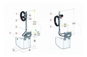
Die Bernardo PTR 11/140 Schutzeinrichtungen für diverse Maschinen sind speziell entwickelt, um den Bediener vor direktem Kontakt mit rotierenden Teilen der Spindel und vor wegfliegenden Spänen sowie Kühlmittelspritzern zu schützen. Diese Vorrichtung verfügt über ein doppeltes Befestigungssystem, welches durch einstellbare Sechskantarme gehalten wird. Der Sicherheits-Mikroschalter ist im Spezialscharnier integriert, welches den Schutzschirm trägt.
