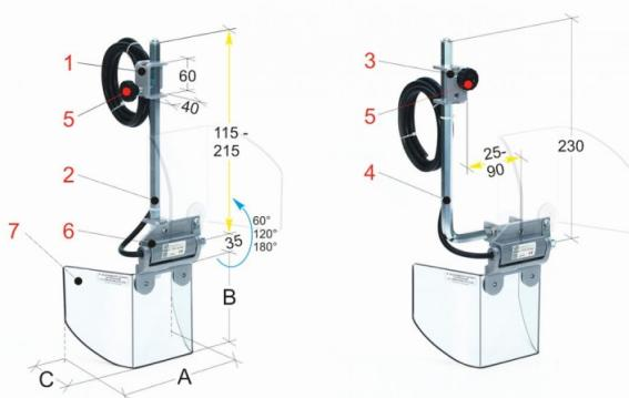
Die Bernardo PTR 10/140 Schutzeinrichtungen für diverse Maschinen sind speziell entwickelt, um den Bediener vor direktem Kontakt mit rotierenden Teilen der Spindel und vor wegfliegenden Spänen sowie Kühlmittelspritzern zu schützen. Die Vorrichtung verfügt über ein doppeltes Befestigungssystem, welches durch einstellbare Sechskantarme gehalten wird. Der Sicherheits-Mikroschalter ist im Spezialscharnier integriert, welches den Schutzschirm trägt.
