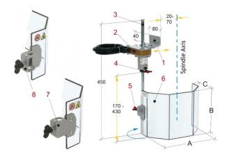
Der Bernardo PTR 02/180 ist eine Schutzeinrichtung für Bohrmaschinen. Diese Schutzeinrichtung besteht aus verschiedenen Komponenten, die für den sicheren Betrieb einer Bohrmaschine erforderlich sind.
