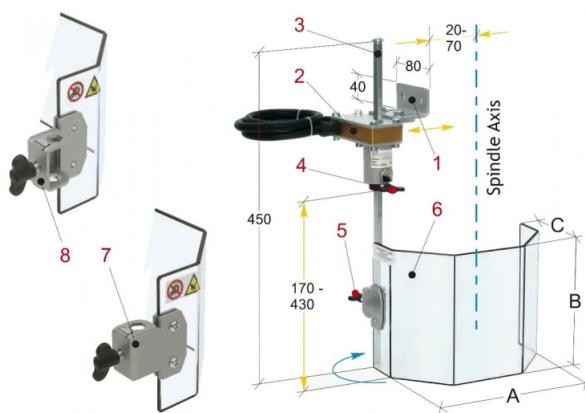
Die Bernardo PTR 02/130 Schutzeinrichtungen für Bohrmaschinen sind stabil und vielseitig. Sie schützen den Bediener vor direktem Kontakt mit der rotierenden Spindel und wegfliegenden Spänen oder Kühlmittelspritzern.
