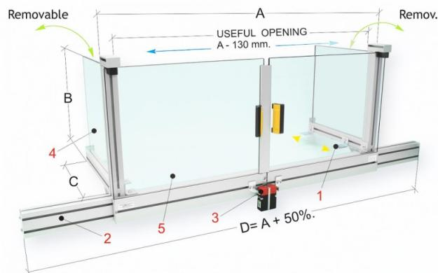
Der Bernardo PFR 40/860 ist eine Schutzeinrichtung für die Installation auf dem Maschinentisch. Sie schützt den Bediener vor direktem Kontakt mit rotierenden Teilen der Spindel und vor wegfliegenden Spänen und Kühlmittelspritzern.
