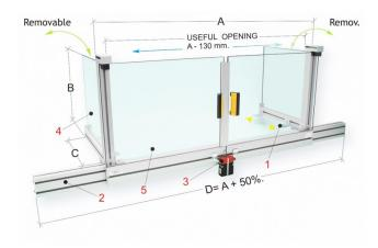
Der Bernardo PFR 40/755 ist eine Schutzeinrichtung für die Installation auf dem Maschinentisch. Diese Schutzeinrichtung ist ausgestattet mit einem Winkelhalter aus Stahlblech, einem Rahmen aus Aluminiumprofil, einem Sicherheits-Mikroschalter mit getrenntem Auslöser und 2 Öffnungskontakten, abnehmbaren Seitenteilen aus schlagfestem, ölbeständigem Kunststoffmaterial und einem vorderen Schutzschirm.
