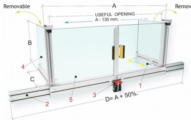
Der Bernardo PFR 40/755 ist eine Schutzeinrichtung für die Installation auf dem Maschinentisch. Sie schützt den Bediener vor direktem Kontakt mit rotierenden Teilen der Spindel und vor wegfliegenden Spänen und Kühlmittelspritzern.
