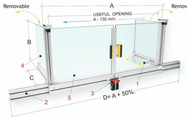
Der Bernardo PFR 40/650 ist eine Schutzeinrichtung für die Installation auf dem Maschinentisch. Sie schützt den Bediener vor direktem Kontakt mit rotierenden Teilen der Spindel und vor wegfliegenden Spänen und Kühlmittelspritzern.
