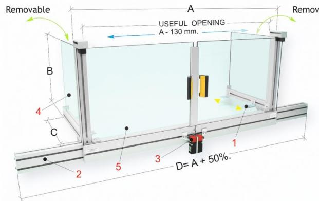
Der Bernardo PFR 40/545 ist eine Schutzeinrichtung für die Installation auf dem Maschinentisch. Diese Schutzeinrichtung ist mit zwei Schiebetüren und abnehmbaren Seitenteilen ausgestattet. Sie schützt den Bediener vor direktem Kontakt mit rotierenden Teilen der Spindel und vor wegfliegenden Spänen und Kühlmittelspritzern.
