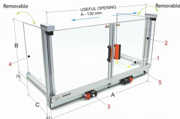
Der Bernardo PFR 30/650 ist eine Schutzeinrichtung für die Installation auf dem Maschinentisch. Sie schützt den Bediener vor direktem Kontakt mit rotierenden Teilen der Spindel und vor wegfliegenden Spänen und Kühlmittelspritzern. Die Schutzeinrichtung ist mit zwei Schiebetüren und abnehmbaren Seitenteilen ausgestattet.
