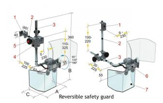
Die Bernardo PFR 20/218 Schutzeinrichtungen für Fräsmaschinen sind mit einem vertikal zu öffnendem Schutzschirm ausgestattet. Der Mikroschalter ist im Scharnier eingebaut und schützt den Bediener vor direktem Kontakt mit der Vertikalspindel und wegfliegenden Spänen oder Kühlmittelspritzern.
