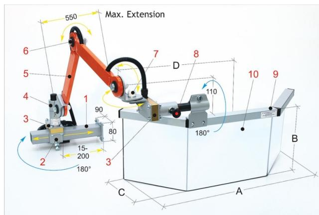
Die Bernardo PFR 02/725/.. Schutzeinrichtungen für Fräsmaschinen bieten eine Vielzahl an Schwenkmöglichkeiten und sind somit unser vielseitigstes Modell. Dieses Modell schützt den Bediener vor direktem Kontakt mit der Vertikalspindel und wegfliegenden Spänen oder Kühlmittelspritzern.
