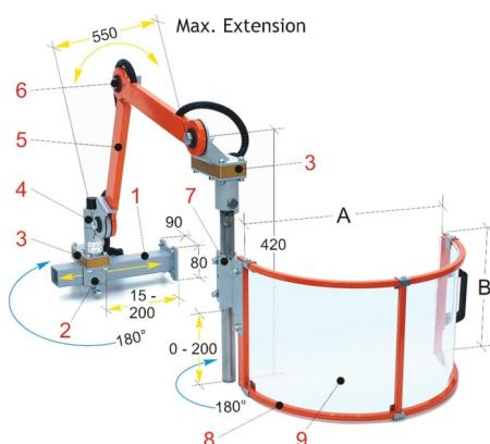
Die Bernardo PFR 01/400/.. Schutzeinrichtungen für Fräsmaschinen sind klassische Universalschutzeinrichtungen mit Gelenkkarmen. Sie schützen den Bediener vor direktem Kontakt mit der Vertikalspindel und wegfliegenden Spänen oder Kühlmittelspritzern. Die Schutzeinrichtungen sind am Maschinenständer montierbar und ausgestattet mit einem halbrunden Schutzschirm mit doppeltem Öffnungssystem.
