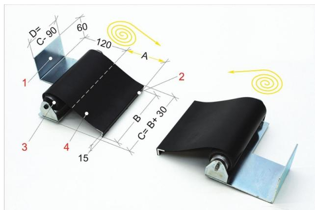
Die Bernardo PAT 01/150 Schutzeinrichtungen für Drehmaschinen besteht aus zwei selbstaufrollenden Bändern, mit tropf- und ölbeständiger Beschichtung. Sie schützt den Bediener vor direktem Kontakt mit der Leit- und Zugspindel und vermeidet die Gefahr, dass die Arbeitskleidung erfasst wird.
