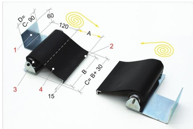
Die Bernardo PAT 01/120 Schutzeinrichtungen für Drehmaschinen besteht aus zwei selbstaufrollenden Bändern, mit tropf- und ölständiger Beschichtung. Sie schützt den Bediener vor direktem Kontakt mit der Leit- und Zugspindel und vermeidet die Gefahr, dass die Arbeitskleidung erfasst wird.
