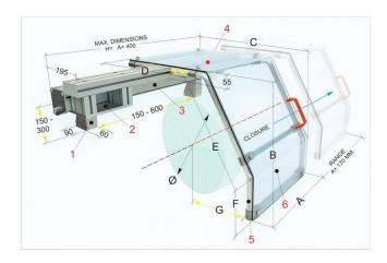
Der Bernardo PTO 20/800 ist eine Schutzeinrichtung für Drehmaschinen. Die folgenden technischen Daten sind verfügbar:
