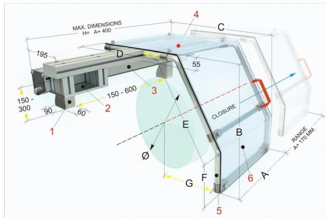
Die Bernardo PTO 20/600 Schutzeinrichtungen für Drehmaschinen sind speziell für den sicheren Schutz des Bedieners vor den bewegten Teilen der Drehmaschine konstruiert. Die Montage erfolgt am Spindelkopf und schützt den Bediener vor dem direkten Kontakt mit rotierenden Teilen des Spannfutters und vor wegfliegenden Spänen sowie Kühlmittelspritzern.
