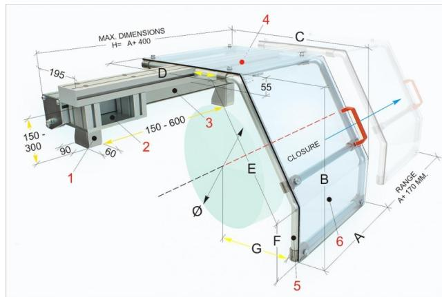
Die Bernardo PTO 20/400 Schutzeinrichtungen für Drehmaschinen sind besonders stabile und funktionelle Schutzauben, welche für den sicheren Schutz des Bedieners vor den bewegten Teilen der Drehmaschine konstruiert wurden.
