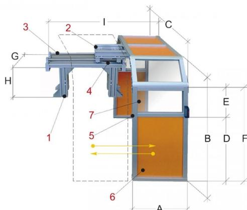
Die Bernardo PTO 22/1200 Schutzeinrichtungen für Drehmaschinen ist eine verschiebbare Schutzeinrichtung für große Drehmaschinen, ausgestattet mit beidseitigem Schutzschirm für Maschinen ohne Spänerückwand. Das Modell schützt den Bediener vor direktem Kontakt mit rotierenden Teilen des Spannfutters und vor wegfliegenden Spänen, sowie vor Kühlmittelspritzern.
