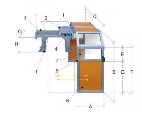
Der Bernardo PTO 22/1200 ist eine Schutzeinrichtung für Drehmaschinen. Diese Schutzeinrichtung besteht aus einer Tragkonstruktion aus Aluminium, einem Schiebeschlitten mit Wälzlager, einer doppelten Stahlführung für den Schiebeschlitten, einer Verriegelung mittels Mikroschalter, einem abnehmbaren Aluminiumrahmen, einem Schutzschild aus Stahlblech und einem transparenten Schutzschirm aus Polycarbonat.
