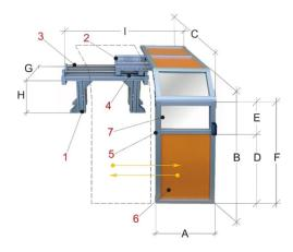
Der Bernardo PTO 21/0800 ist eine Schutzeinrichtung für Drehmaschinen. Die Konstruktion besteht aus einer Tragkonstruktion aus Aluminium, einem Schiebeschlitten mit Wälzlager, einer doppelten Stahlführung für den Schiebeschlitten, einer Verriegelung mittels Mikroschalter, einem abnehmbaren Aluminiumrahmen, einem Schutzschild aus Stahlblech und einem transparenten Schutzschirm aus Polycarbonat.
