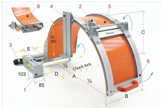
Die Bernardo PTO 04/100 Schutzeinrichtungen für Drehmaschinen sind außerordentlich robust und bieten Schutz vor direktem Kontakt mit dem rotierendem Spannfutter, heißen Spänen und Kühlmittelspritzern. Die stabile Ausführung der Trägerkonstruktion erlaubt eine einfache Befestigung an der Rückseite der Drehmaschine und falls erforderlich auch an der Vorderseite.
