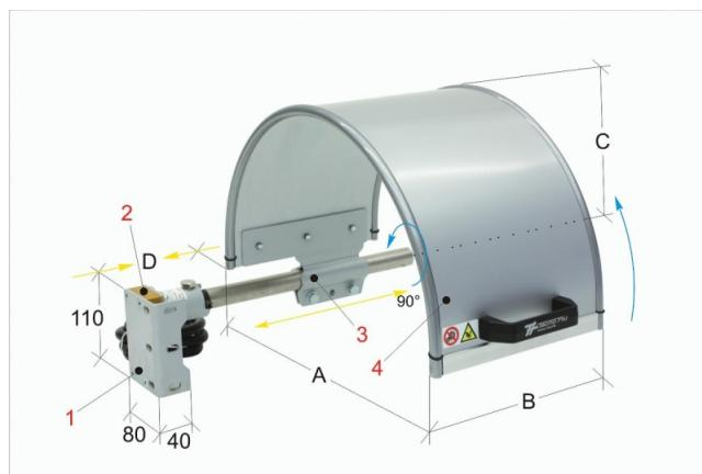
Das Modell PTO 03 wird direkt am Spindelkopf montiert. Der Schirm besteht aus einem undurchsichtigen Aluminium-Verbundwerkstoff. Dieses Modell ist in verschiedenen Größen verfügbar und schützt den Bediener vor direktem Kontakt mit dem Spannfutter der Drehmaschine und vor heißen Spänen, Öl und Kühlmittel.
