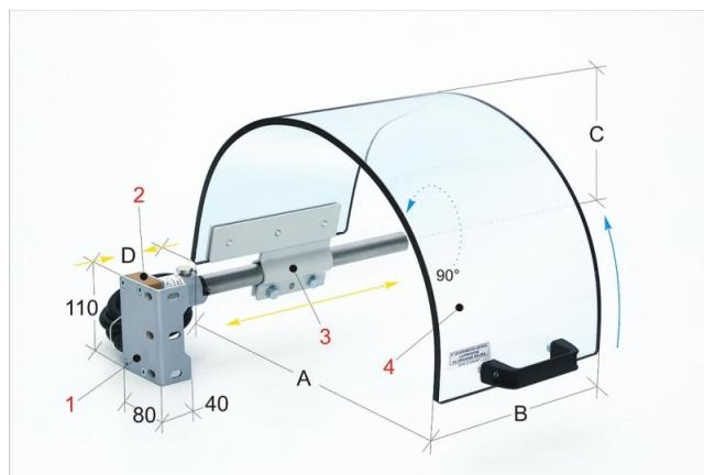
Das Modell PTO 02 wird direkt am Spindelkopf montiert. Der Schirm besteht aus schlagfestem und ölbeständigem Kunststoffmaterial. Dieses Modell ist in verschiedenen Größen verfügbar und schützt den Bediener vor direktem Kontakt mit dem Spannfutter der Drehmaschine und vor heißen Spänen, Öl bzw. Kühlmittelspritzern.
