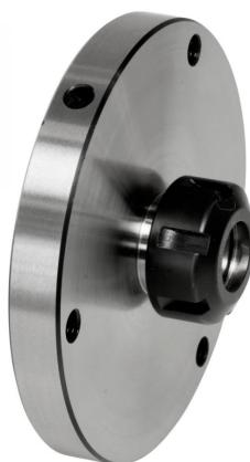
Das Bernardo Spannzangenfutter ER 25 - D 100 ist ein Spannmittel für Werkzeuge. Es hat eine Dicke von 100 mm, eine D1 von 132 mm, einen Durchmesser d von 25 mm, eine Gewindegroße T von M32 x 1,5 und eine Länge L von 34 mm. Es ist für die Spannzange ER 25 geeignet.
