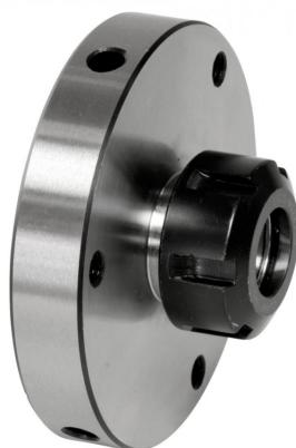
Das Bernardo Spannzangenfutter ER 25 - D 72 ist ein Spannmittel für Werkzeuge. Es hat eine Dicke von 72 mm, einen Außendurchmesser von 100 mm, einen Innendurchmesser von 25 mm, eine Gewindegroße von M32 x 1,5 und eine Länge von 36 mm. Es ist für die Verwendung mit ER 25 Spannzangen geeignet.
