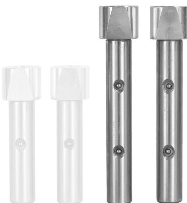
Das Bernardo Rundbankhakenset lang (2 Stk.) ist ein Zubehör für Hobelbänke, das zum Spannen unterschiedlichster Werkstücke auf einfache Art und Weise dient. Durch den abgeschrägten Spannkopf entsteht ein Niederzugseffekt, der das Werkstück gegen die Arbeitsplatte spannt. Der Spannkopf ist aus Aluminium, um etwaige Schäden der Werkzeuge zu verhindern. Die Höhenverstellung der Bankhaken ist einfach durch einstellbare Druckelemente möglich.
