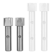
Das Bernardo Rundbankhakenset kurz (2 Stk.) ist ein Zubehör für Hobelbänke, das zum Spannen unterschiedlichster Werkstücke auf einfache Art und Weise dient. Durch den abgeschrägten Spannkopf entsteht ein Niederzugseffekt, der das Werkstück gegen die Arbeitsplatte spannt. Der Spannkopf ist aus Aluminium, um etwaige Schäden der Werkzeuge zu verhindern. Die Höhenverstellung der Bankhaken ist einfach durch einstellbare Druckelemente möglich.
